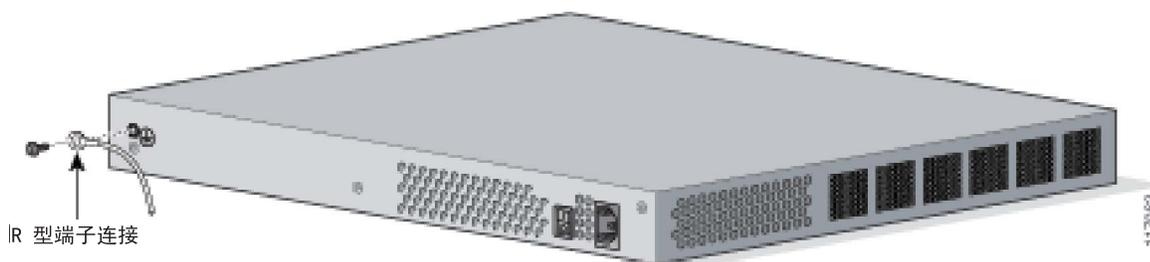
**图 11** Cisco 2811 机箱符合 NEBS 标准的机箱接地连接
